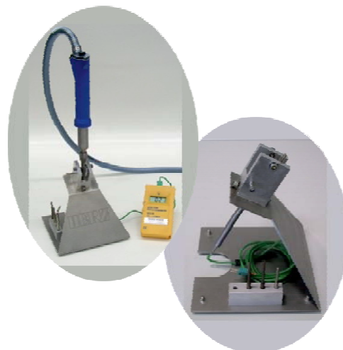
Stanice na měření teploty
