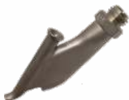
Rychlosvářecí tryska pro kruhový drát se závitem M10 Ø 3mm Obj. č. 5410175 SSD3 Ø 4mm Obj. č. 5410176 SSD4 Ø 5mm Obj. č. 5410177 SSD5
